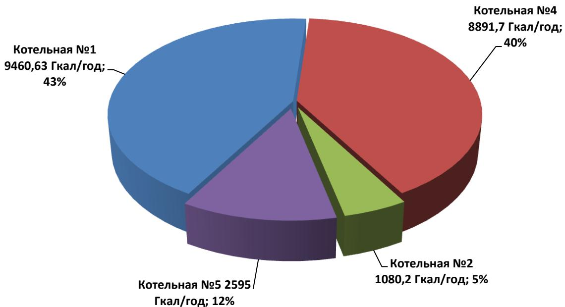
Рис.2 Выработка тепловой энергии котельными №1,2,4,5.
