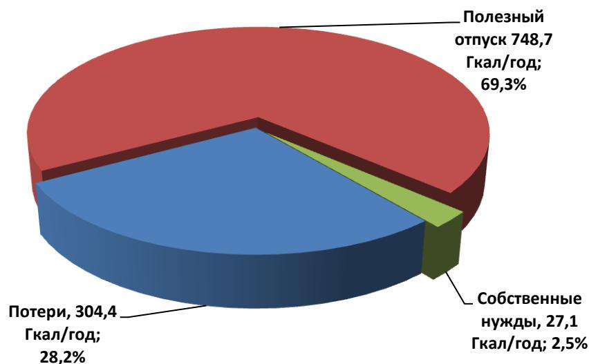
Рис.4 Тепловой баланс котельной №2.
