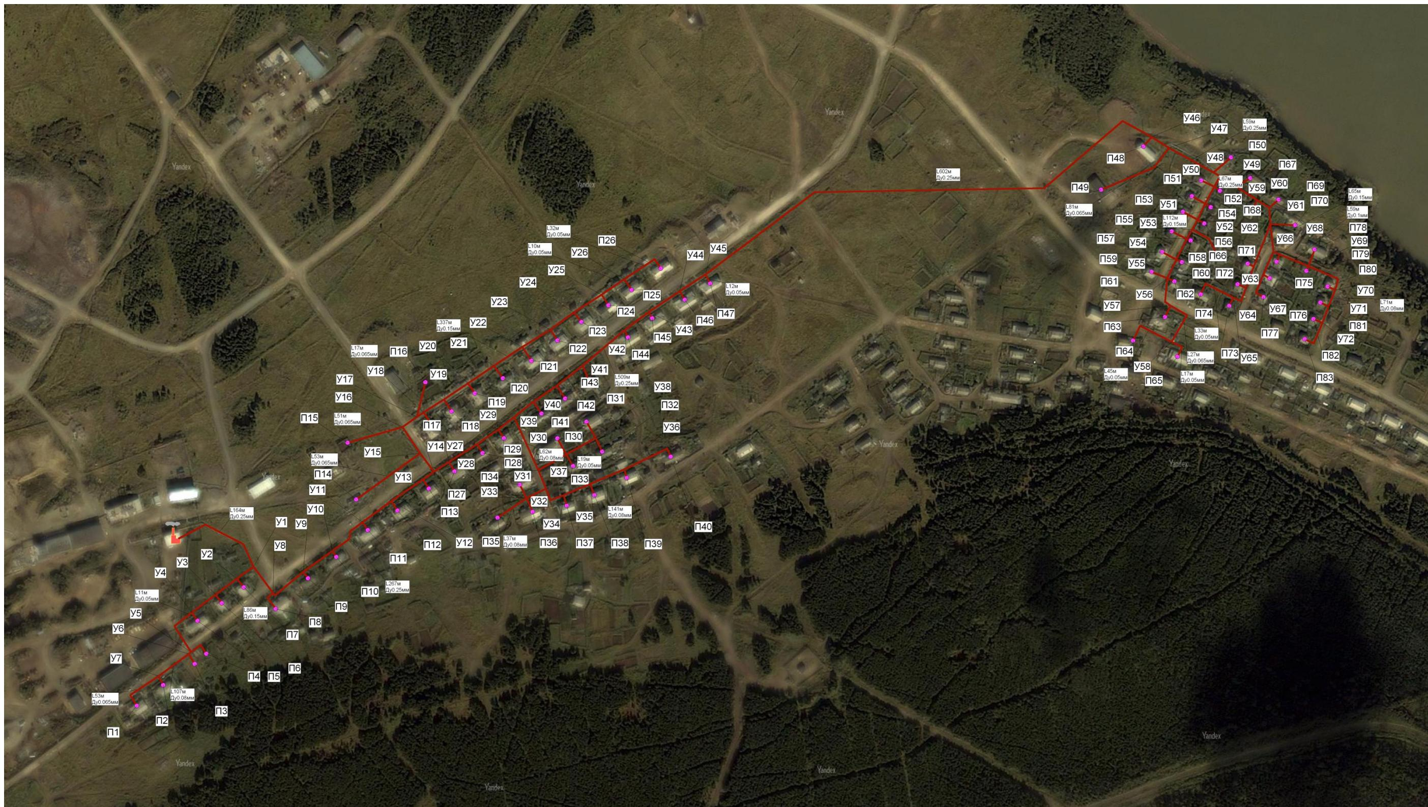
Рис. 2.2. Схема теплоснабжения от котельной №4
