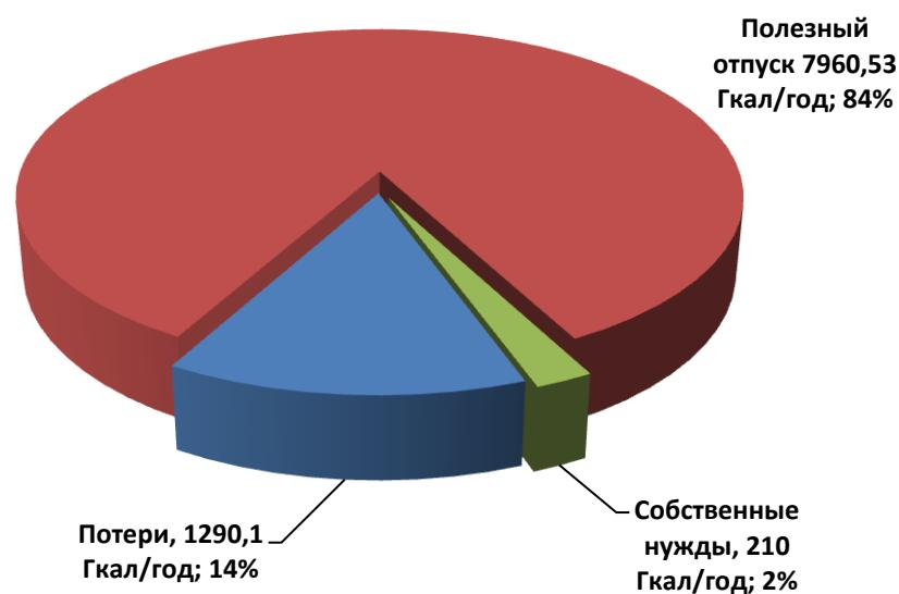
Рис.3 Тепловой баланс котельной №1.
