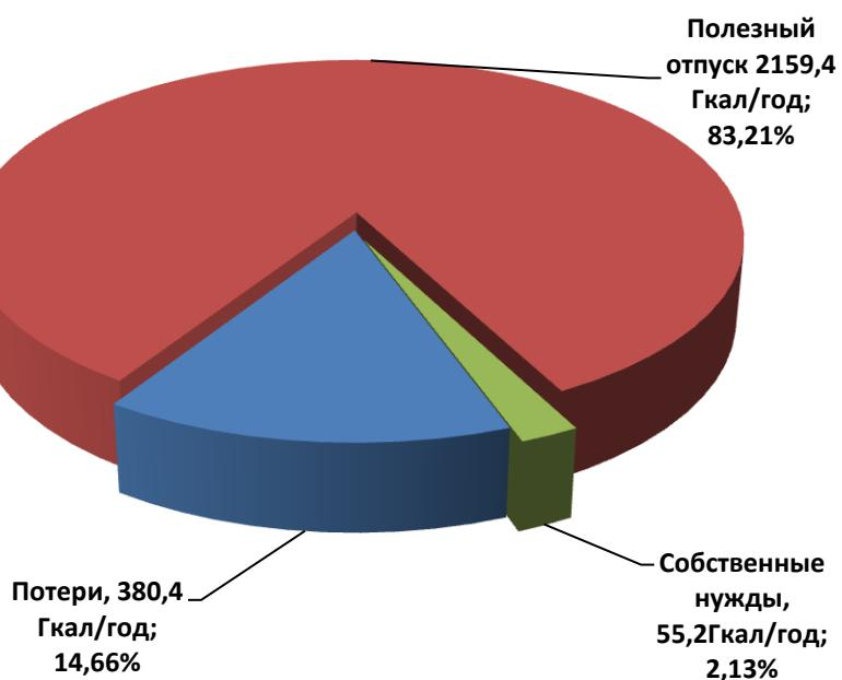
Рис.6 Тепловой баланс котельной №5.
