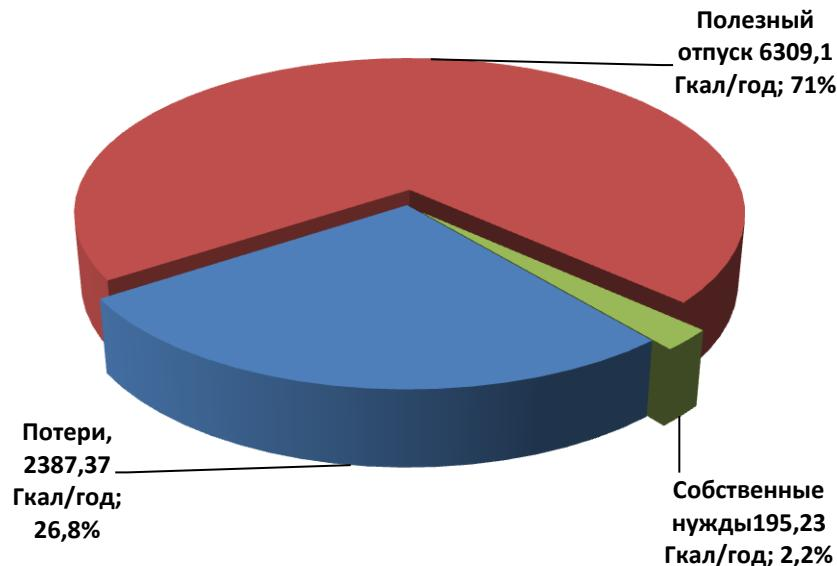
Рис.5 Тепловой баланс котельной №4.
